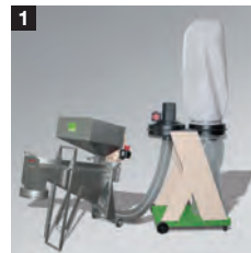
Der vom Getreidekorn abgebürstete Staubanteil wird hygienisch über eine kompakte Absauganlage mit Luftfilter in einen Folien sack abgesaugt.
