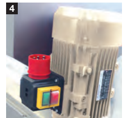
Ein starker Industriemotor mit aufgebautem Motorschutzschalter treibt die Maschine an.
