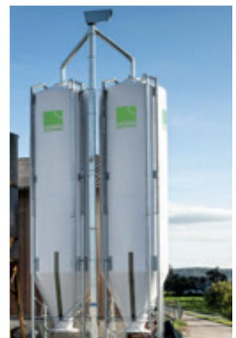
GFK-Silos mit Kettenelevator
