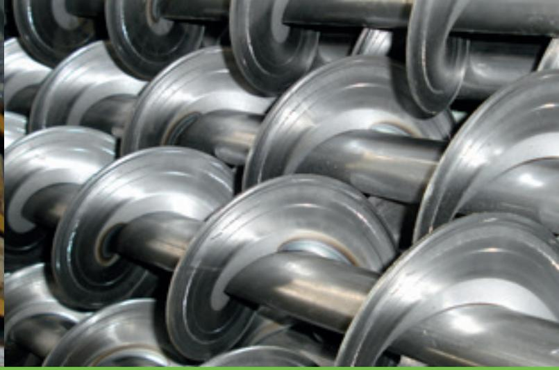
**1 Dinkelschäler:** schälen, trennen und reinigen in einem Arbeitsgang. Leistung / Rohware bis zu 1,5 t/h.
