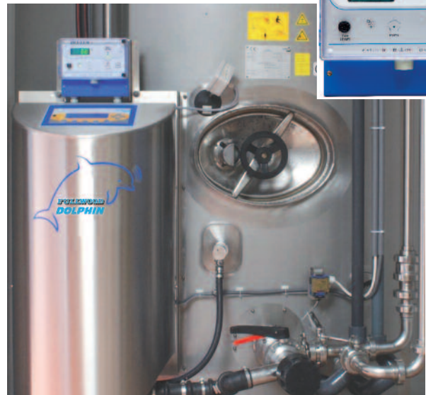
Oculus 3 kontrolliert und dokumentiert rund um die Uhr sämtliche Funktionen der Milchkühlung und der angeschlossenen Kühltankreinigung. Werkfoto
